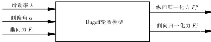
图 2 Dugoff 轮胎模型原理图
