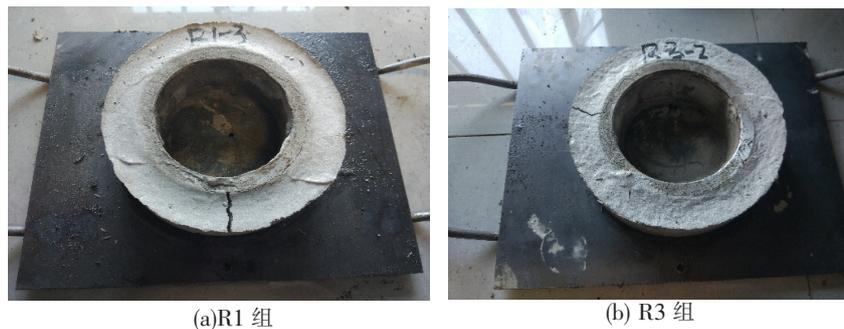
图 1 环形约束收缩试件裂缝图
