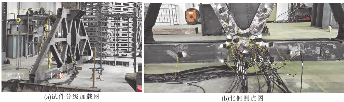
图 8 疲劳试验加载
