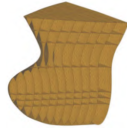
图 3 船艏有限元模型
