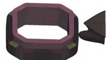
图 6 密贴连接有限元碰撞模型
