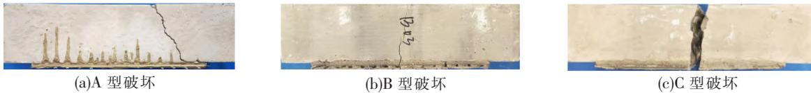
图 5 试件破坏形态
