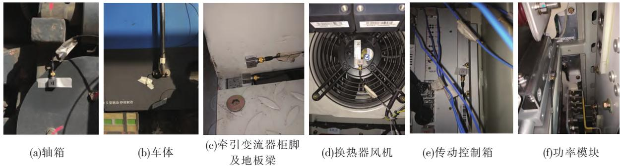
图 2 振动测点布置
