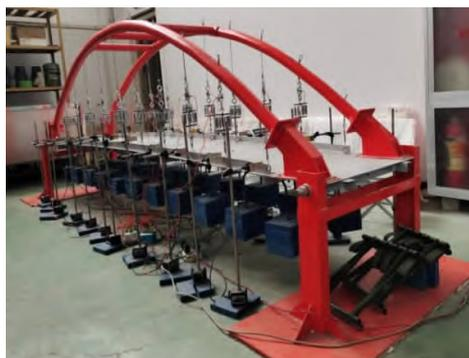
图 2 下承式拱桥实验模型
