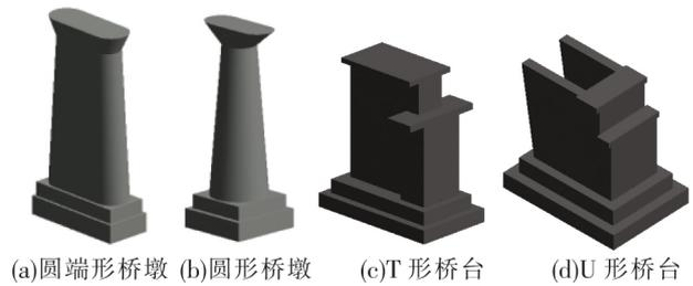
图 4 重力式桥墩和桥台
