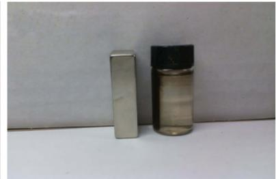
图 4  $\text{NiFe}_2\text{O}_4$ -G 在磁铁旁的光学照片
