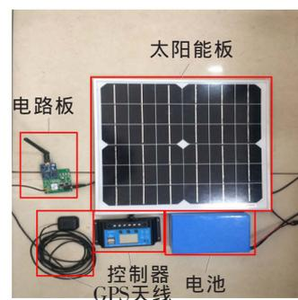
图 2 终端节点结构图
