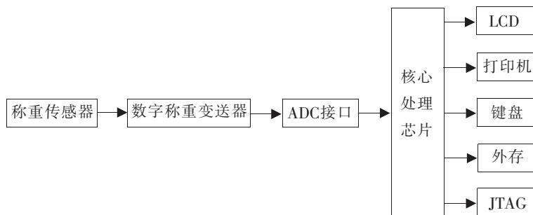
图 3 称重计量系统结构图
