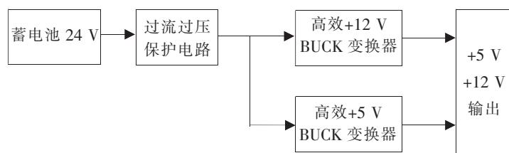
图4 电源模块变换电路框图
