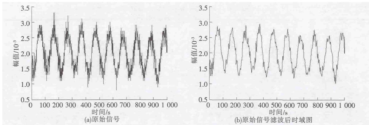
图8 小波变换后的数据波形
