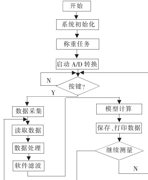
图 7 主程序流程
