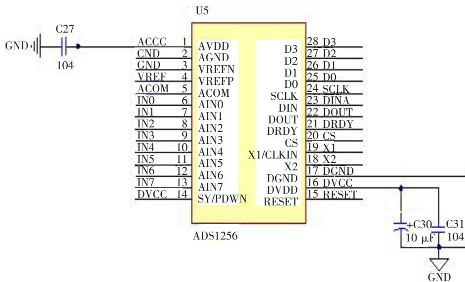
图 6 ADS1256 主控电路
