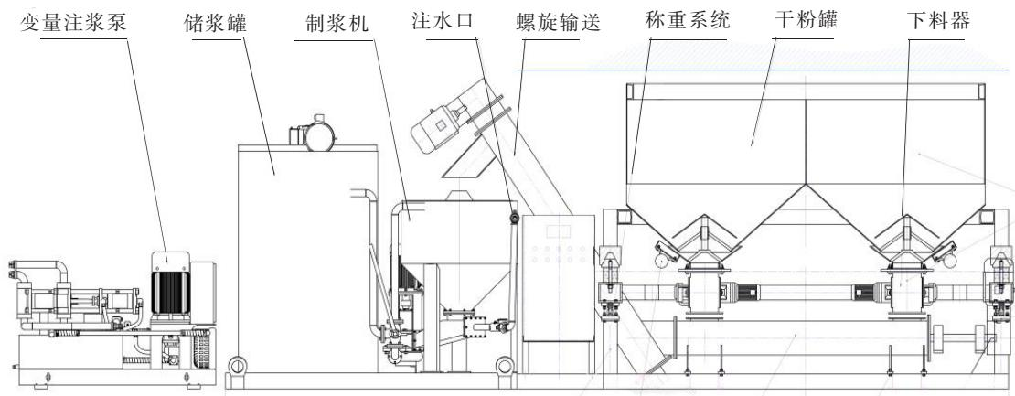
图1 一体化注浆设备结构图
