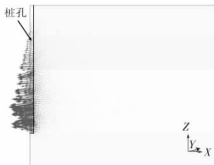
图 3 单孔引发土体位移矢量图
