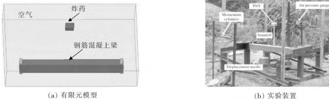
图 2 有限元模型及实验装置图<sup>[9]</sup>
