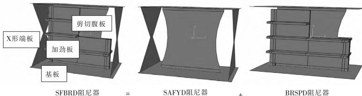
图 1 软钢阻尼器模型
