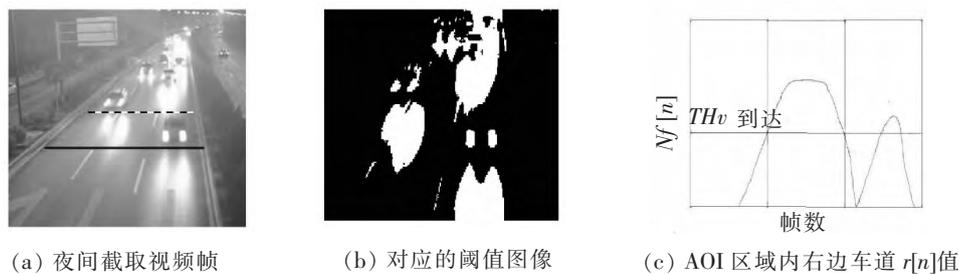
图 6 有限状态机在夜间车辆检测上的应用
