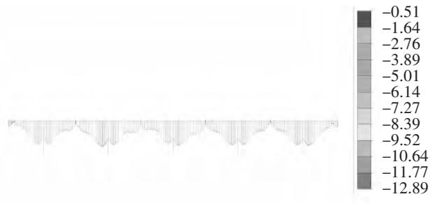
图 9 (传统顺序)短期组合主梁下缘应力(单位:MPa)
