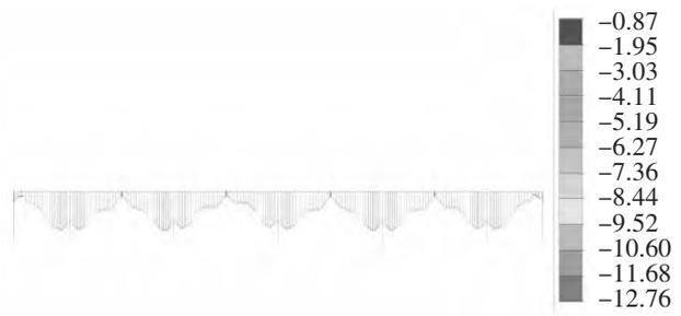
图 12 (优化顺序)短期组合主梁下缘应力(单位:MPa)
