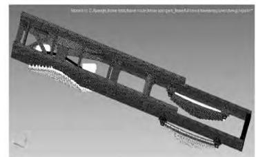
图 5 车架有限元模型
