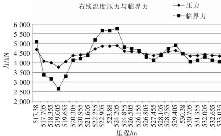
图 6 右线底座板厚度不足段压力与临界力
