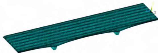
图 2 连续梁桥全桥有限元模型
