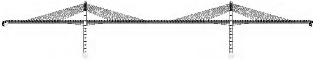
图 2 中跨长距离等截面矮塔斜拉桥结构离散图
