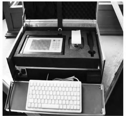
图 4 EV2 静态变形模量仪
