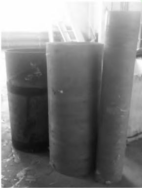
图 2 玻璃钢管试件
