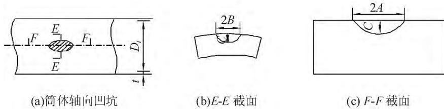
图 2 规则化轴向凹坑示意图
