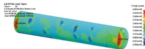
图 5 压力容器应力云图
