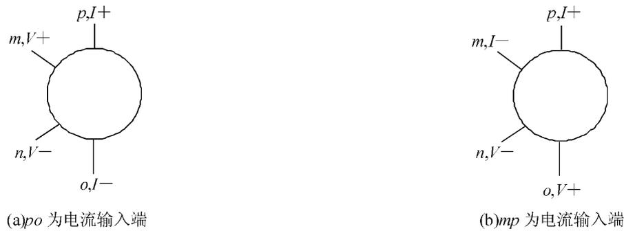
图 4 试验采用电极布置图
