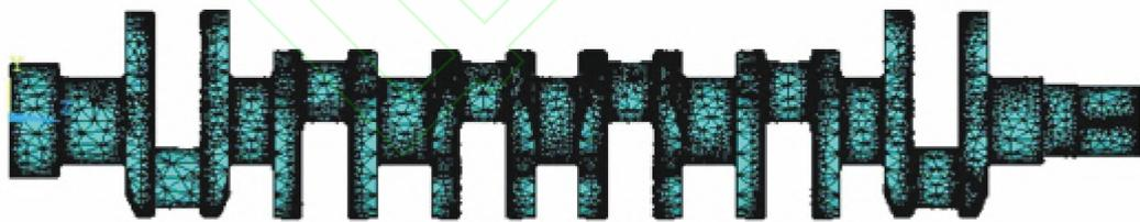
图 2 曲轴的柔性化模型
