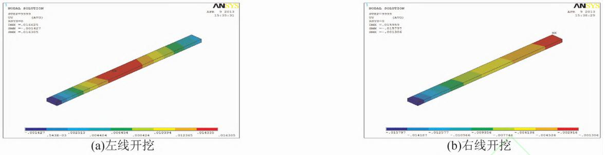
图 11 开挖至监测面处污水管底板不均匀沉降(单位:m)
