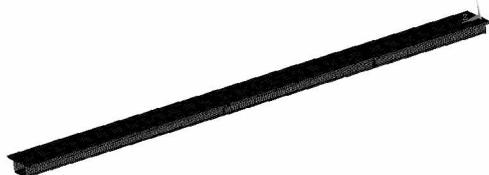
图 2 双面组合连续箱梁有限元模型
