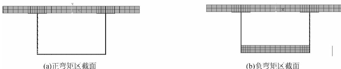
图 3 双面组合连续箱梁横截面有限元模型
