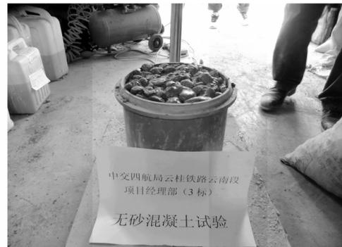
图 2 通过试拌确定合理的稠度
