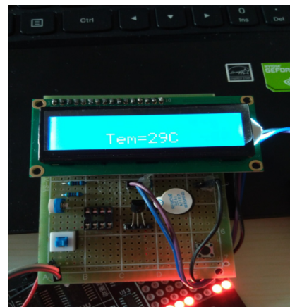
图 6 测温模块简易制作图
